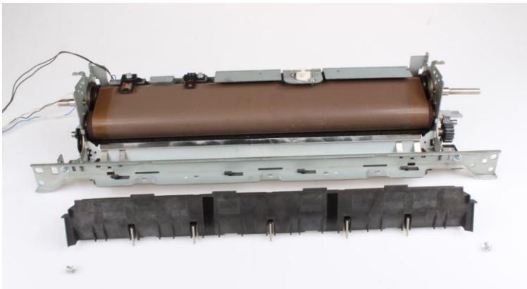
Rysunek 45 Zdjęta listwa z separatorami
