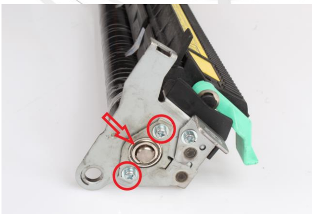
Rysunek 39 Blaszka mocująca łożysko
