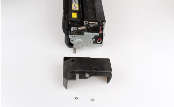
Rysunek 5 Plastikowy boczek z lewej strony po odkręceniu
