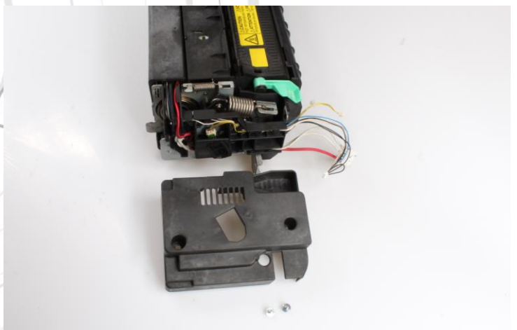
Rysunek 3 Plastikowy boczek z prawej strony po odkręceniu
