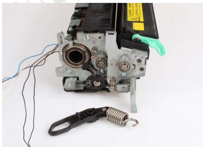
Rysunek 33 Plastik ze sprężyną z prawej strony
