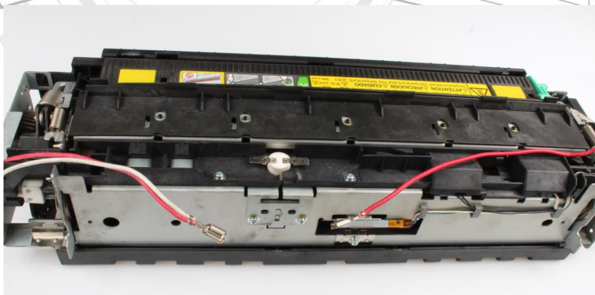
Rysunek 13 Zdejmujemy wsuwki z termostatu.
