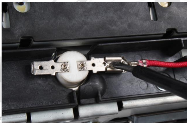
Rysunek 12 Zdejmujemy wsuwki z termostatu.
