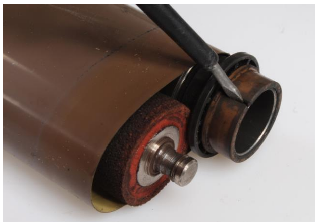
Rysunek 58 Plastikowa tuleja wałka grzejnego
