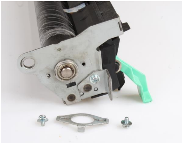
Rysunek 41 Blaszka mocująca łożysko
