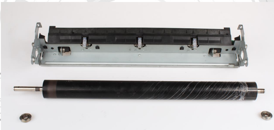
Rysunek 42 Zdjęte łożyska z wałka dociskowego
