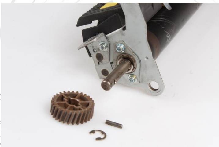
Rysunek 38 Zębátka na wałku dociskowym
