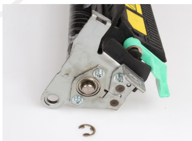
Rysunek 40 Zawleczka zabezpieczająca wałek dociskowy
